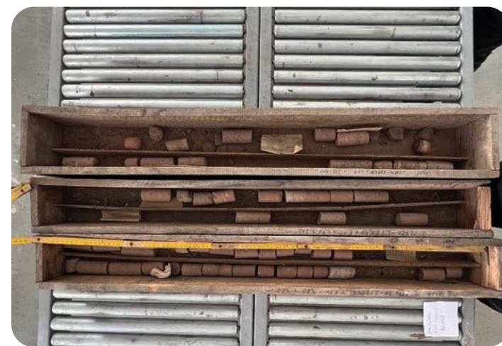
Das digitale Schichtenmodell (l.) zeigt den Untergrund der Stadt Guben bis zu einer Tiefe von etwa 2.500 m. Das Foto von Bohrkernen aus ca. 2.300 m unter Guben stammt aus dem Jahr 1963. Schon damals haben sich Wissenschaftler für das Erdreich interessiert. Die Bohrkernedienten auch bei der aktuellen Studie für Messungen.
