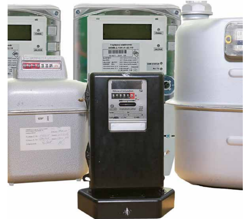
Neben modernen digitalen Zählern ohne Fernzugriffsmöglichkeit sind in zahlreichen Haushalten auch noch ältere analoge Messeinrichtungen verbaut. Diese müssen manuell abgelesen werden. Foto/Montage: SPREE-PR/ml
