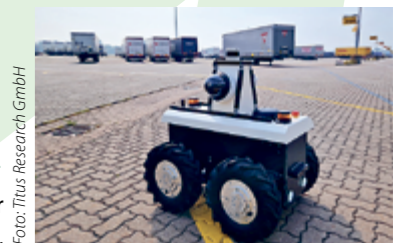
Ein Roboterfahrzeug soll zukünftig die Trailer im Lübecker Hafen erkennen und lokalisieren.
